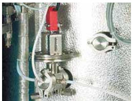
FVG - Membrane safety device for preventing lid opening even in case of minimal over pressure FVG - Membran-Sicherheitsvorrichtung verhindert Deckelöffnung bereits bei geringstem Überdruck
