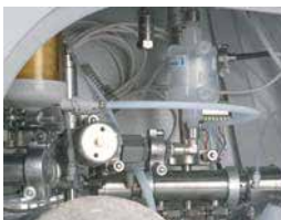
Diaphragm valve in AISI 316 L stainless steel with pneumatic actuator & decontamination of exhaust air with sterile filter / Membranventil aus AISI 316 L Edelstahl mit pneumatischen Stellantrieb & Dekontamination der Abluft über Sterilfilter
