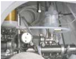
Diaphragm valve in AISI 316 L stainless steel with pneumatic actuator & decontamination of exhaust air with sterile filter / Valvola a membrana in acciaio AISI 316 L con attuatore pneumatico e decontaminazione dell'aria di scarico con filtro sterile
